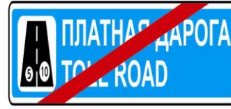
5.43. Конец платной автомобильной дороги
